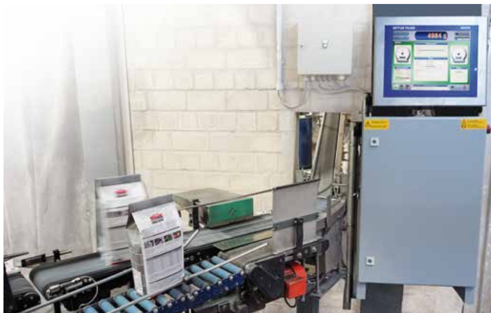
Взвешивание вертикальных мешков с помощью чеквейера XS40
